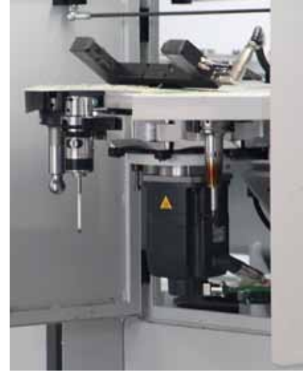
Der Werkzeugwechsler kann, wenn der Arbeitsraum der Maschine geteilt wird, beide Hälften bedienen.
