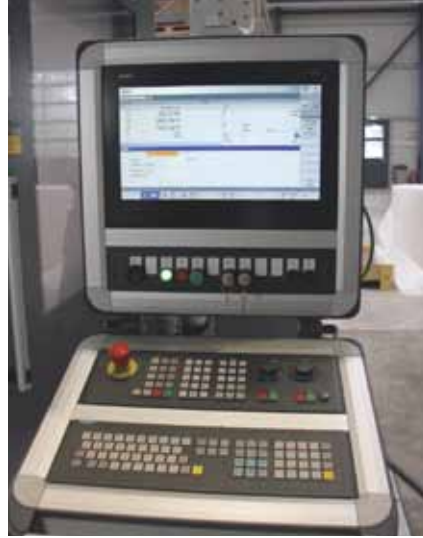
Programmiert wird nicht auf der leistungsfähigen Steuerung Siemens Sinumerik 840D sl, sondern offline auf einem TebisCAD/CAM-System.
