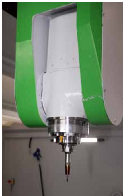
Der stabile Gabelkopf sorgt für eine ruhige, vibrationsarme Bearbeitung.
