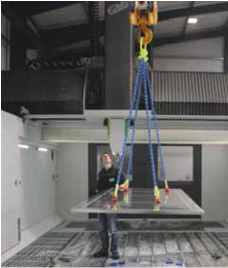
Die EiMa Gamma L kann sowohl per Flurförderzeug als auch via Hallenkran von oben beladen werden.
