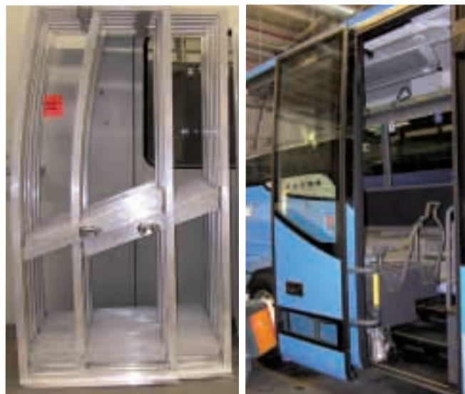
Hans-Jürgen Köhler (o.) von EvoBus zeigt bearbeitete Alu-Profile, die zum Türrahmen verschweißt (l.u.), dann lackiert und schließlich zur fertigen Fahrgasttür montiert werden. (Fotos: ASP)
