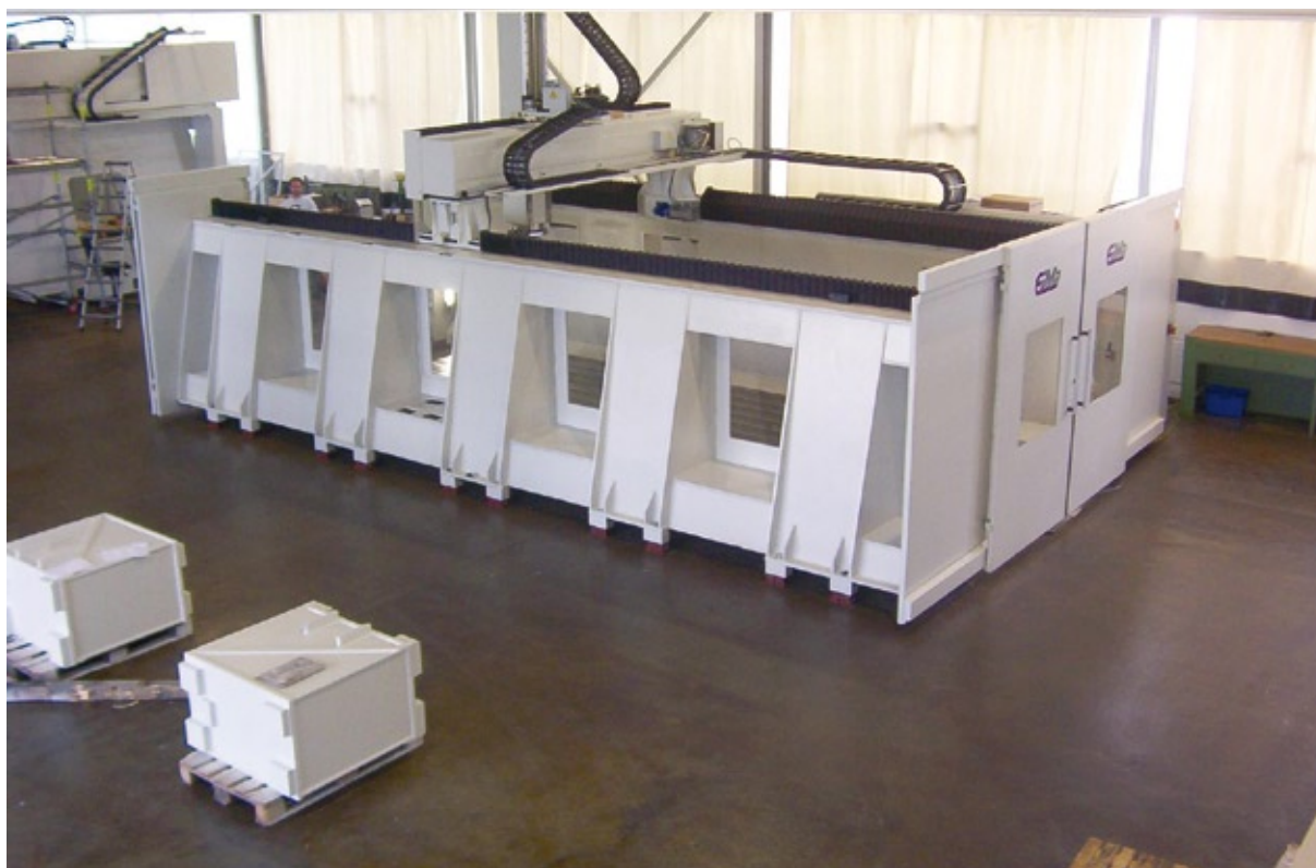
Mit diesem HSC-Fünf-Achs-Fräszentrum für großvolumige Alu- oder CFK-Teile können auch Titan und Stahl bearbeitet werden. Eine Simulation des Siemens-Mechatronik-Support überzeugte den Investor von der Funktionsfähigkeit und Produktivität der innovativen Idee.
