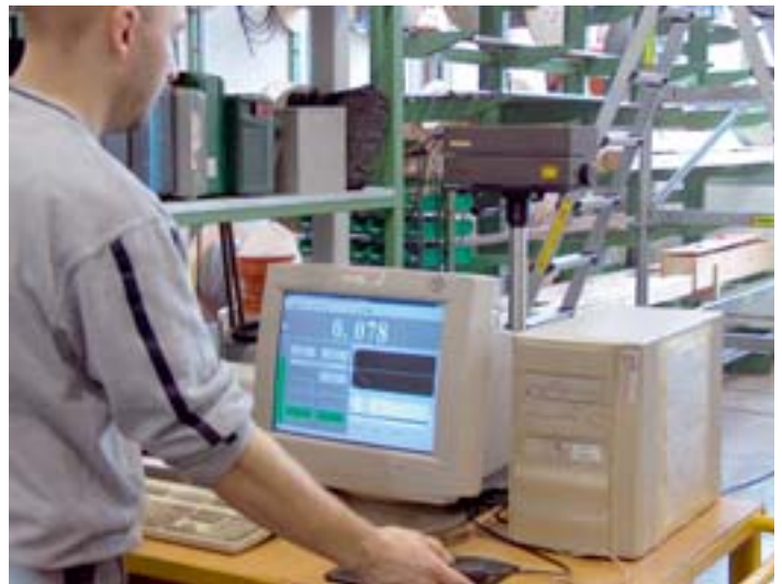
Fehler sofort sichtbar: Am Bildschirm des PC zeigt die Auswertesoftware tabellarisch und grafisch die Abweichungen von der idealen Geradheit
